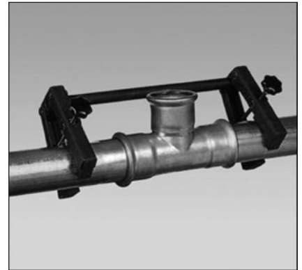
Abb. 17: Verpressen mit Pressbacke
