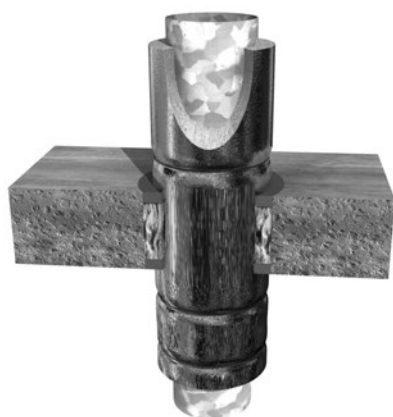
C-Stahl Rohr, direkt in Decke, mit Streckenisolierung aus Steinwolle (Länge mind. 1000 mm in jede Richtung).
